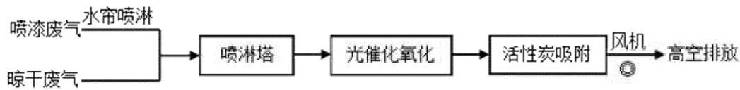
图 4-2 喷漆废气治理工艺流程示意图
