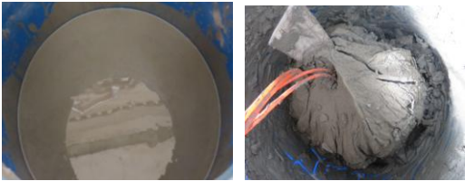
图 8 浆药剂真空预压处理废弃泥前后对比
